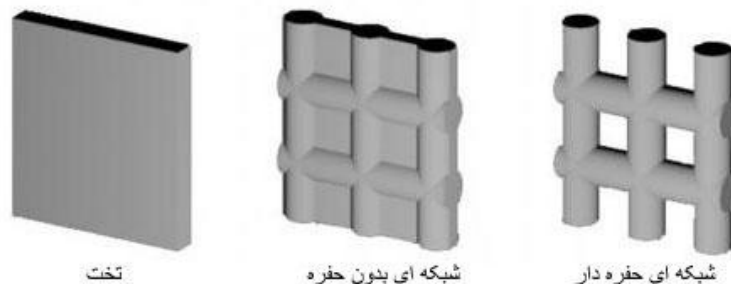
شکل ۱- اشکال هندسی دیوار بتنی سیستم ICF
