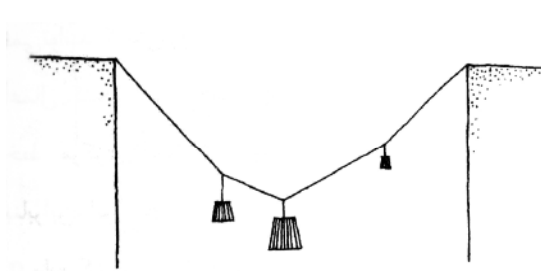
شکل ۱- منحنی طنابی تحت سه بار نقطه‌ای
