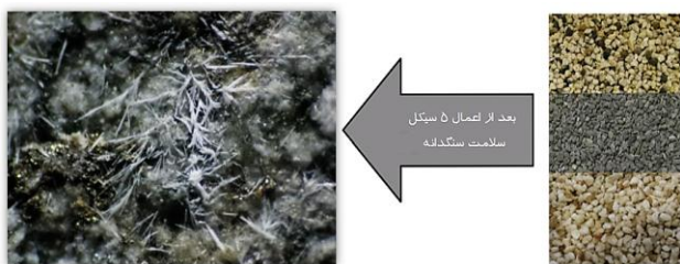
تصویر ۱- تشکیل کریستال های نمک سولفات بعد از اعمال ۵ سیکل آزمایش سلامت سنگدانه [۳]
